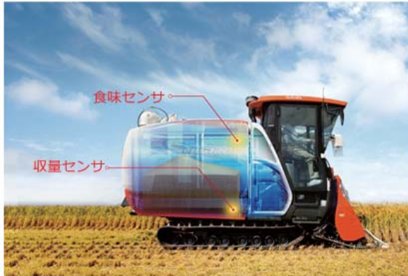
圃場ごとの収量・食味を、刈取りながらデータ化できる。
